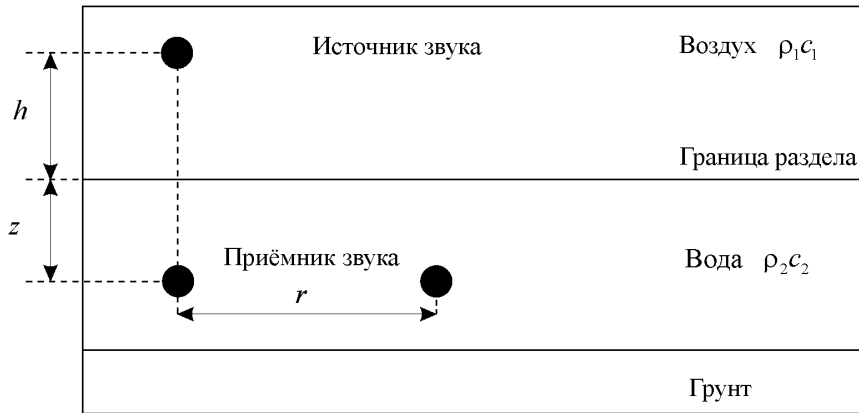
Рис. 1.1. К прохождению инфразвука из воздуха в воду на крайне низких частотах
