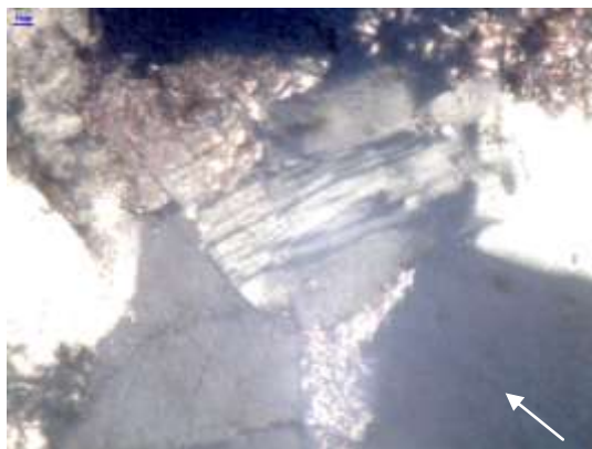
Рисунок 2 – Деформація плагіоклазу із зміщенням двійників (ніколі +), пісковик світи C_2^6 , пр. 5079, ш-та ім. О.Ф. Засядька
