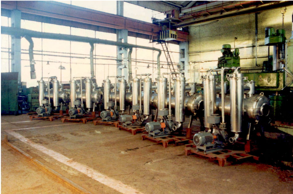
Партія вакуумних гомогенізаторів, виготовлених заводом «Більшовик», готова до відправки на підприємства харчової промисловості
