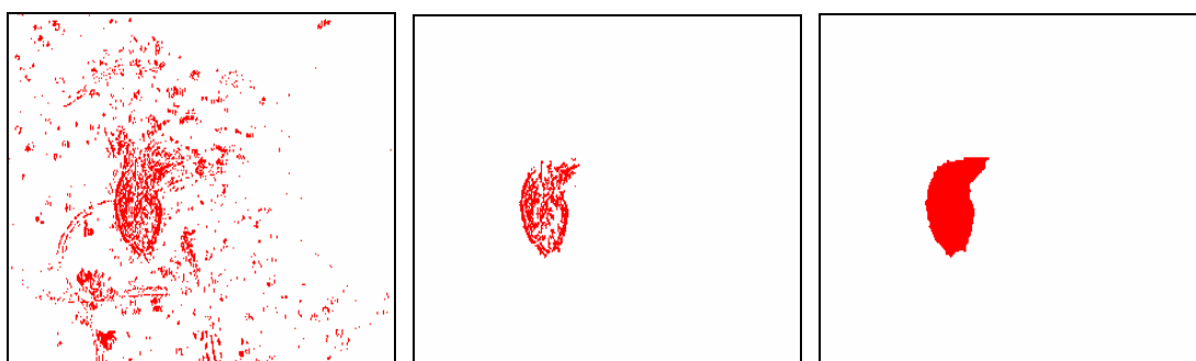
Рисунок 9 – Бинарная обработка образа динамического объекта: а) пороговая сегментация, б) удаление объектов по геометрическим характеристикам, в) морфологическая обработка образа объекта
