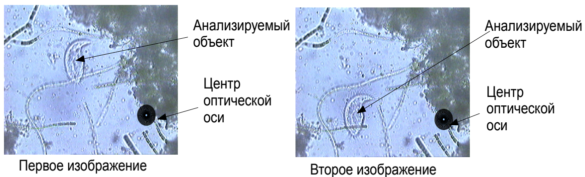
Рисунок 2 – Схема работы стереопары
