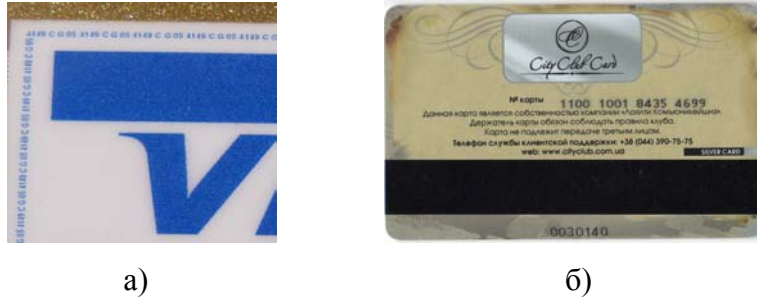
Рисунок 2 – Поліграфічні методи захисту пластикових карток: а) друк мікрошрифту; б) друк номерів
