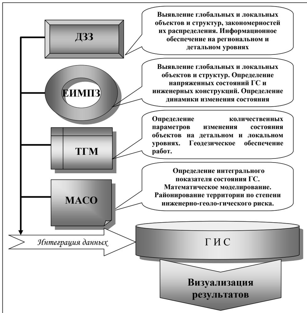
Рис. 4. Технологическая схема комплексного мониторинга ГС.
