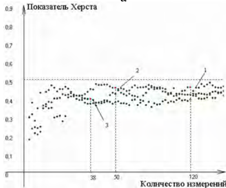
Рис. 8. Изменение значений показателей Херста при различных входных параметрах.
