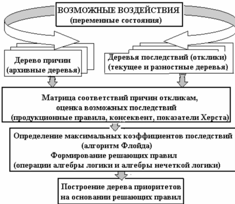
Рис. 7. Схема формирования откликов.
