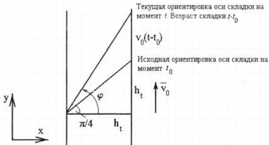
Рис. 14. Схема ротации оси складки в плане на поверхности чехла при сдвиговом течении в зоне разлома: \varphi — текущий угол ориентировки складки; h_t — проекция оси складки на ось Ox ; начальный угол ориентировки оси складки в момент t_0 равен \pi/4
