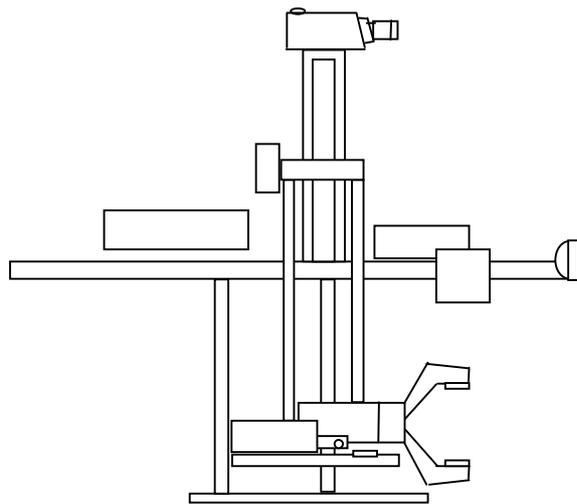
Рисунок 1 – Шагающий робот с манипулятором
