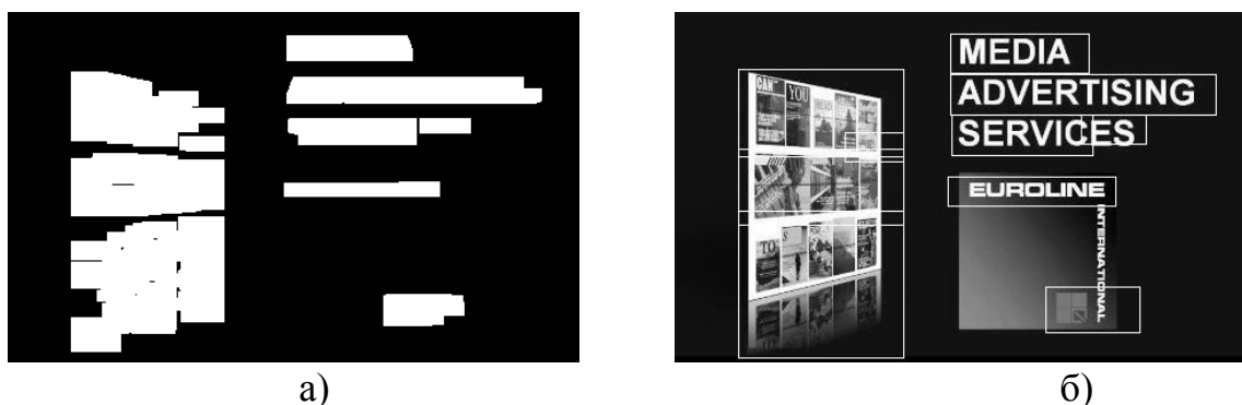
Рисунок 4 – Пример обнаружения текстовых областей с использованием градиентных методов: а) морфологическое открытие изображения; б) полученный результат
