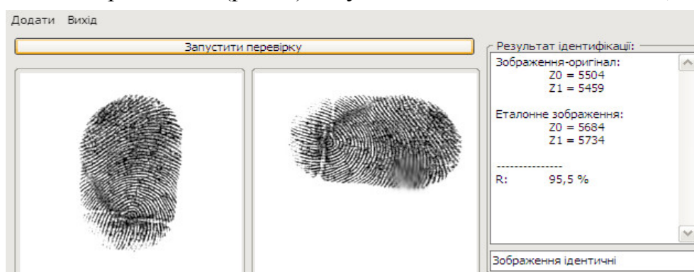
Рисунок 6 – Порівняння зображення-оригіналу з деформовано-розмитим еталонним зображенням
