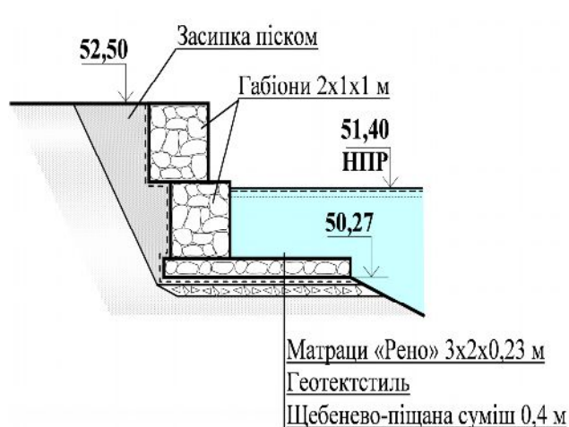
Рисунок 10 – Приклад габіонного укріплення берега
