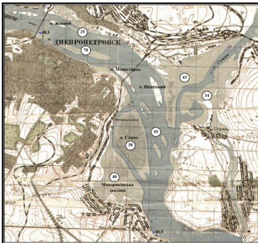
43 - площа затоплених водосховищем земель, островів (га) на різних ділянках акваторії
