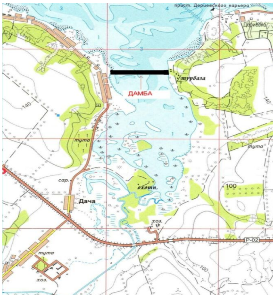
Рисунок 2 – Схема варіанту проекту відокремлення мілководних ділянок ріки дамбою
