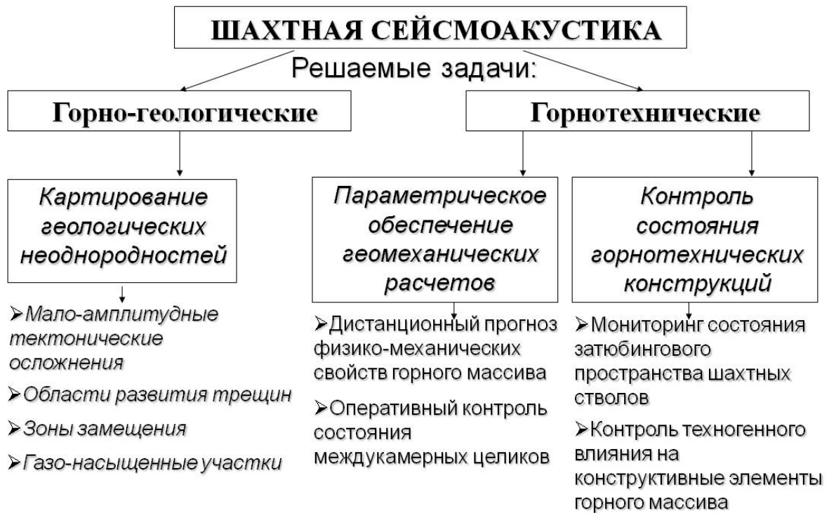
Рис. 1. Применение шахтной сейсмоакустики на ВКМКС
