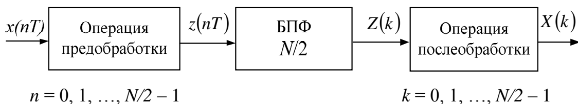
Рисунок 2 – Структурная схема алгоритма вычисления ДПФ одной вещественной последовательности с помощью БПФ размером N/2
