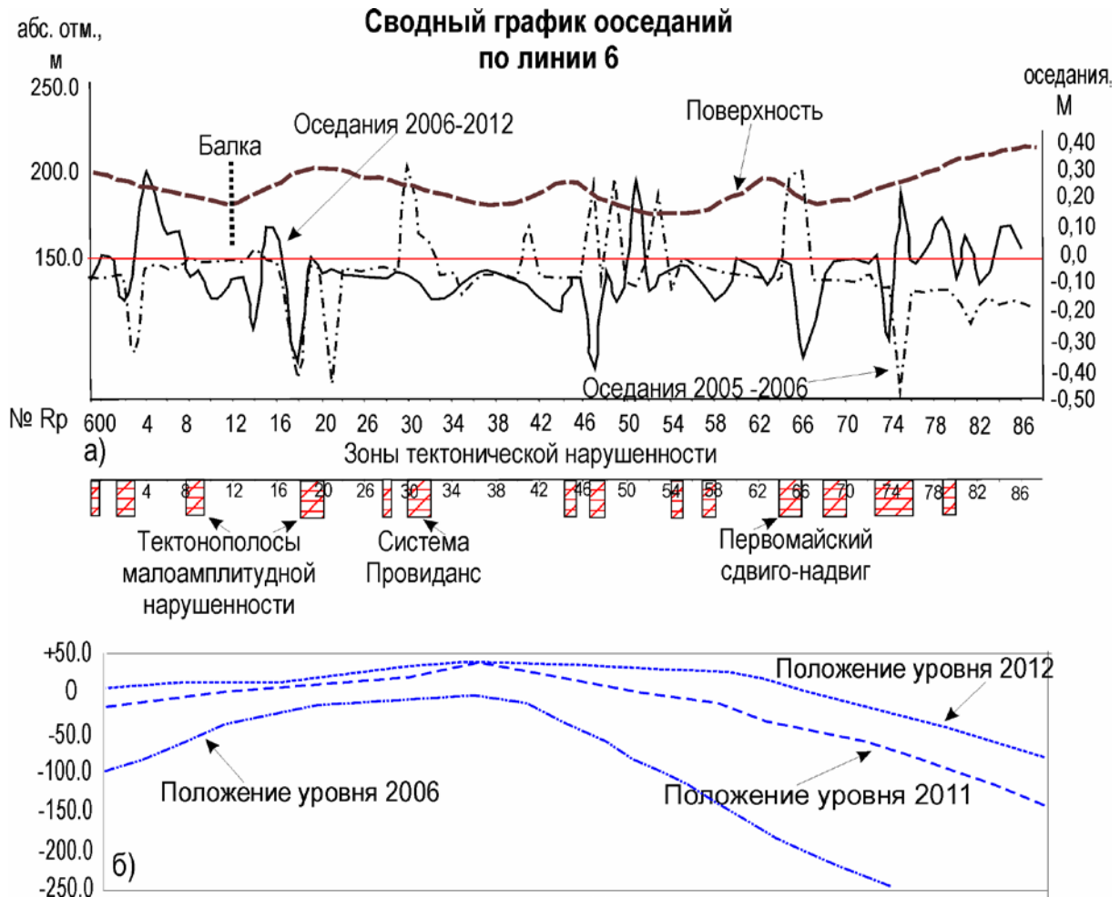
Рис. 4. Сводный график оседаний земной поверхности по линии 6 за два периода геодезических наблюдений с детализацией фактического материала: положение зон тектонической нарушенности вдоль линии геодезического мониторинга (а), положение уровней затопления на рассматриваемые периоды периоды вдоль линии геодезического мониторинга (б)
