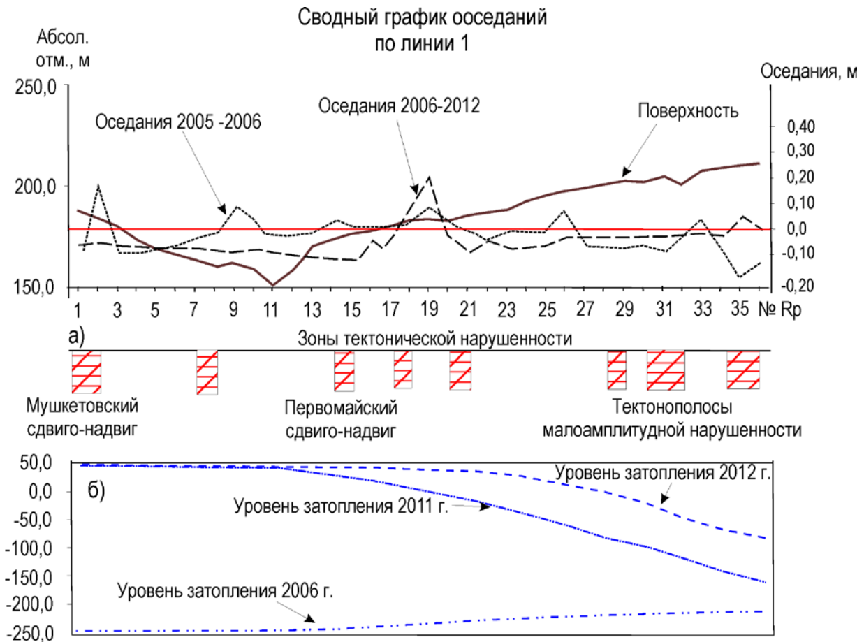
Рис. 2. Сводный график оседаний земной поверхности по линии 1 за два периода геодезических наблюдений с детализацией фактического материала: положение зон тектонической нарушенности вдоль линии геодезического мониторинга (а), положение уровней затопления на рассматриваемые периоды вдоль линии геодезического мониторинга (б)
