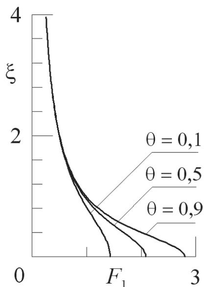
**Р и с. 7.** Зависимости волнового числа от числа Фруда и параметра  $\theta$  для сдвигового течения (19) на мелководье ( $H = 3$  м,  $h = 1$  м)
