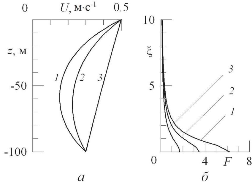
**Р и с. 5.** Строго выпуклые вниз распределения скорости течения при  $H = 100$  м,  $U_0 = 0,5$  м·с<sup>-1</sup>,  $U_1 = 0,3$  м·с<sup>-1</sup> (а) и зависимости безразмерного волнового числа от числа Фруда (б): 1 —  $\alpha_1 = 10^{-3}$  м<sup>-2</sup>; 2 —  $\alpha_1 = 5 \cdot 10^{-4}$  м<sup>-2</sup>; 3 —  $\alpha_1 = 10^{-5}$  м<sup>-2</sup>
