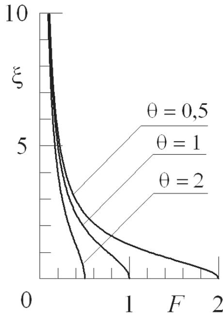
**Р и с. 3.** Зависимости волнового числа от числа Фруда в случае линейного по вертикали изменения горизонтальной скорости течения для различных значений отношения  $\theta$  скорости потока у дна к скорости потока у свободной поверхности
