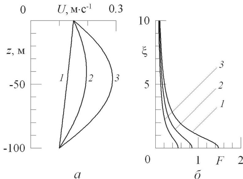
**Р и с. 6.** Строго выпуклые вверх распределения скорости течения при  $H = 100$  м,  $U_0 = 0,15$  м·с<sup>-1</sup>,  $U_1 = 0,1$  м·с<sup>-1</sup> (а) и зависимости безразмерного волнового числа от числа Фруда (б): 1 —  $\alpha_2 = 10^{-5}$  м<sup>-2</sup>; 2 —  $\alpha_2 = 3 \cdot 10^{-4}$  м<sup>-2</sup>; 3 —  $\alpha_2 = 5 \cdot 10^{-4}$  м<sup>-2</sup>
