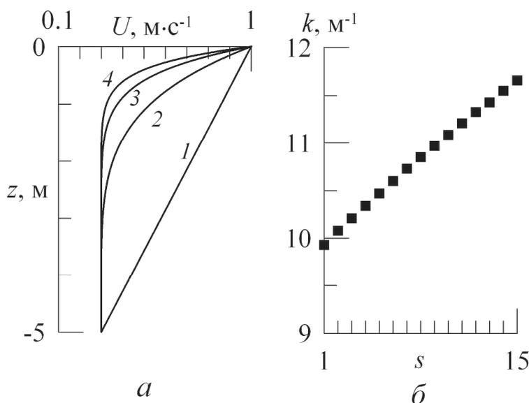
**Р и с. 8.** Распределения по вертикали скорости течения (25) при значениях показателя степени  $s = 1, 5, 10, 15$  (а) и найденные волновые числа при  $s = \overline{1, 15}$  (б). Параметры потока:  $H = 5$  м,  $U_0 = 1,0$  м·с<sup>-1</sup>,  $U_1 = 0,3$  м·с<sup>-1</sup>
