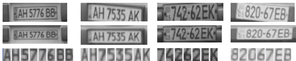
Рисунок 6 – Примеры работы алгоритмов нормализации изображения номера и сегментации символов
