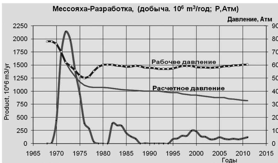
Рис. 5. Изменение пластового давления при разработке Мессояхского газогидратного месторождения
