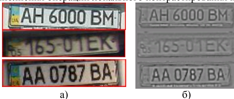
Рисунок 5 – Пример локального контрастирования изображений номерных знаков: исходные изображения (а), результат локального контрастирования (б)
