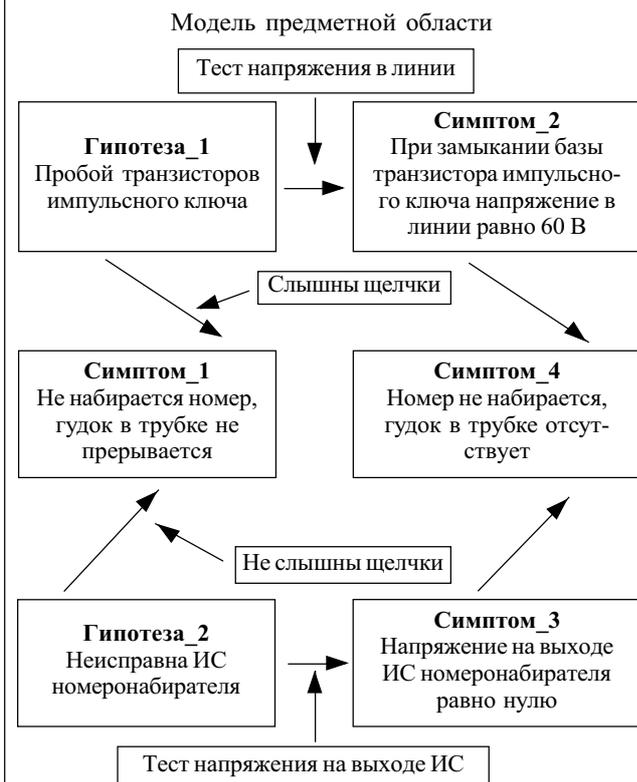
**симптом\_3** — напряжение на выходе ИС номерабиравателя равно нулю;
