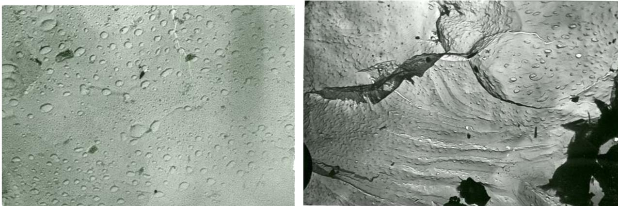
Рис. 2 - Губчатая структура в кварце карбоновых песчаников Донбасса (ув. 2000<sup>X</sup>).
