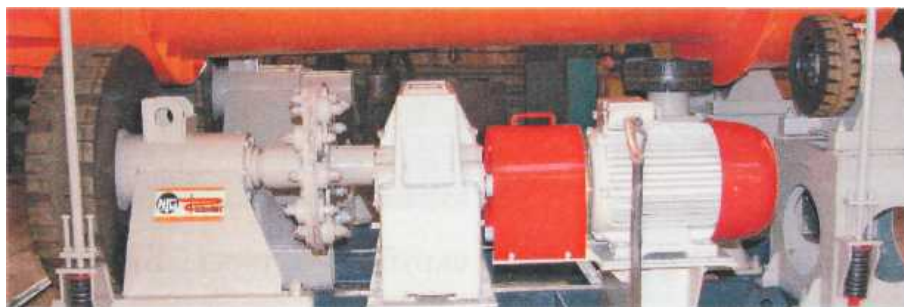
Рис. 4 - Привод скруббер-бутары СБР-100
