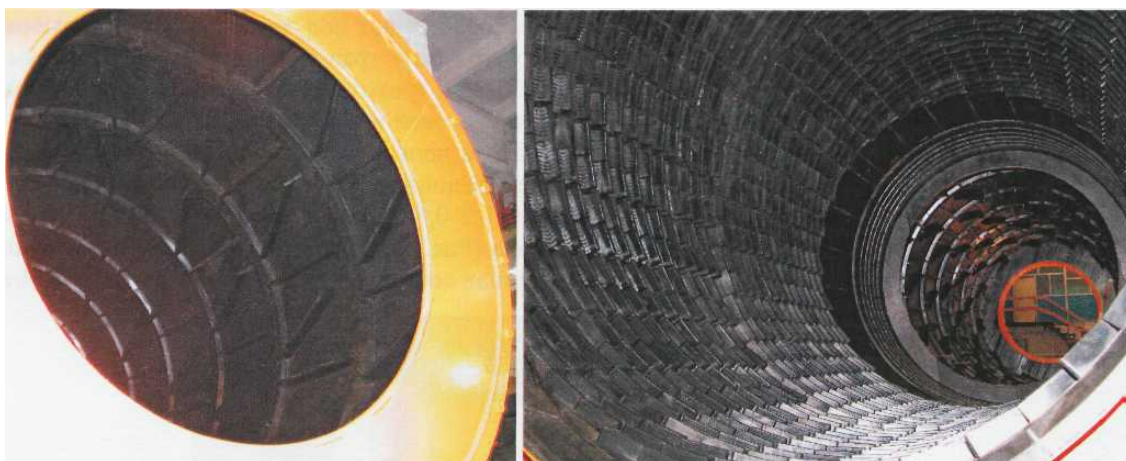
Рис. 3 - Внутренние рабочие поверхности скруббер-будары СБР-100
