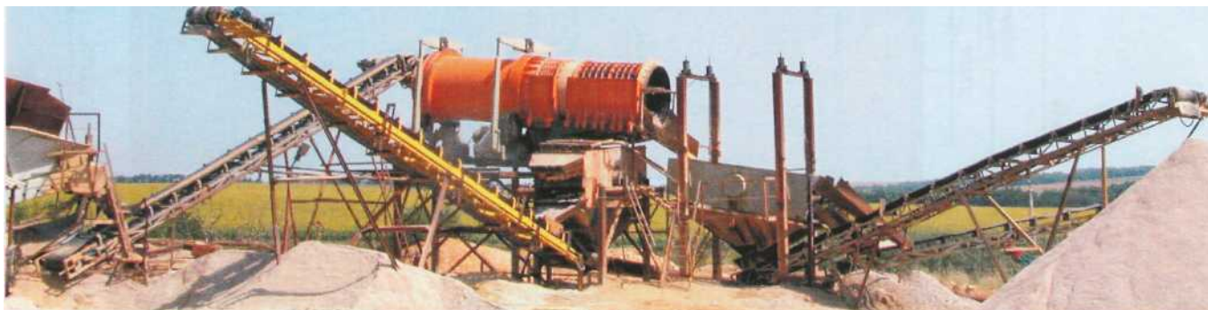
Рис. 1 - Промывочно-сортировочный комплекс со скруббер-бутарой СБР-100.
