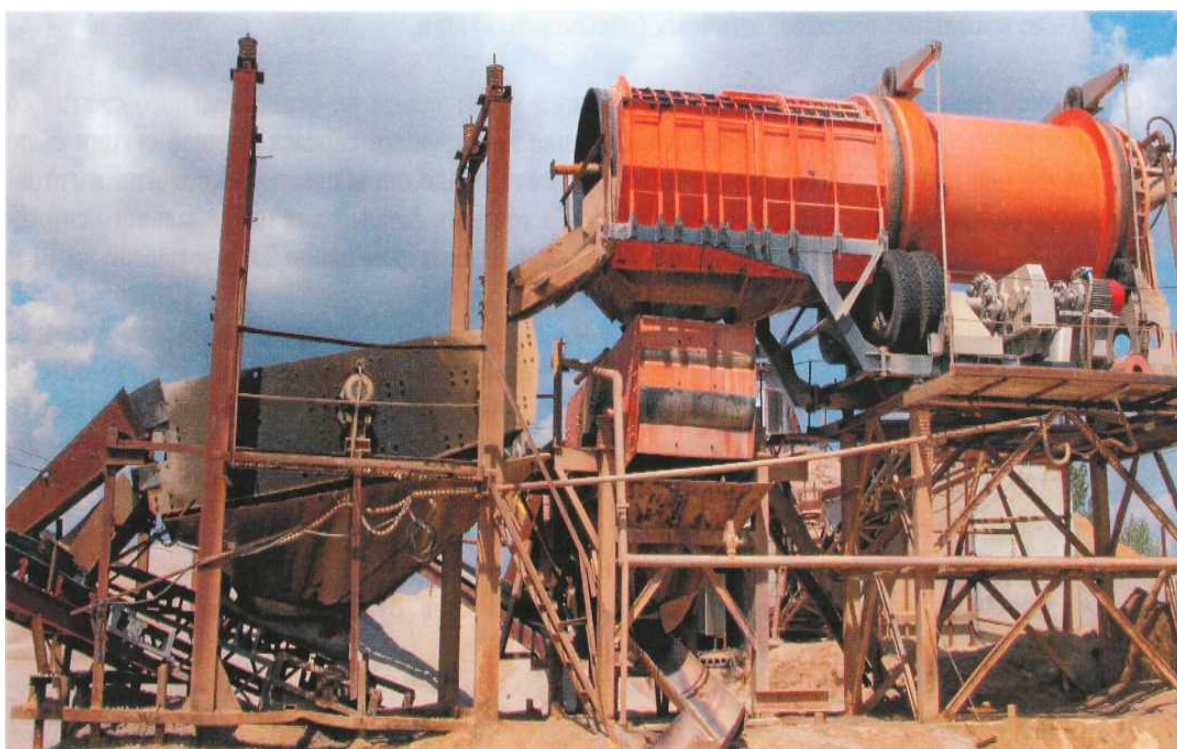
Рис. 6 - Промывочно-сортировочный комплекс по переработке кварцитов Васильковско-го месторождения с модернизированной скруббер-бутарой СБР-100.
