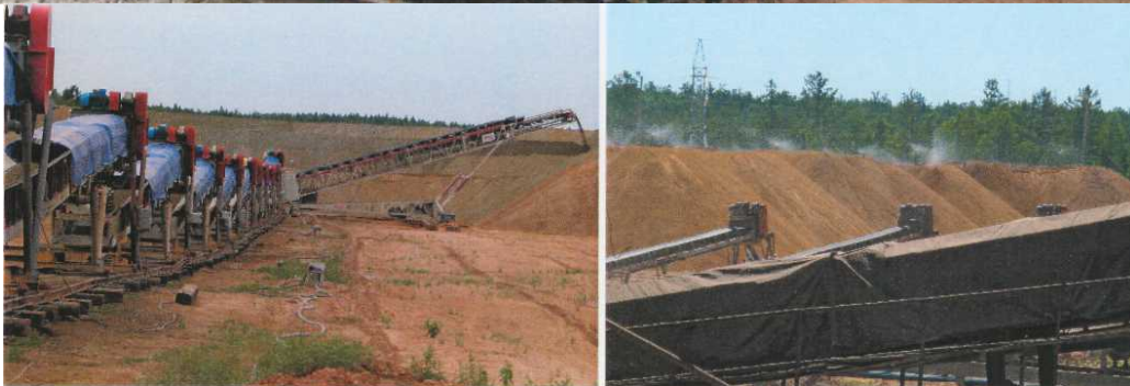
Рис. 11 - Барабанный окомкователь ОБР 2,5х9 в технологической линии кучного выщелачивания золота предприятия «Покровский рудник» УК Петропавловск.
