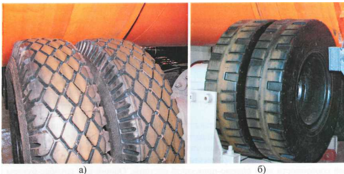
Рис. 7 - Экспериментальные опорно-приводные колёсные пары скруббер-бутары СБР-100.
