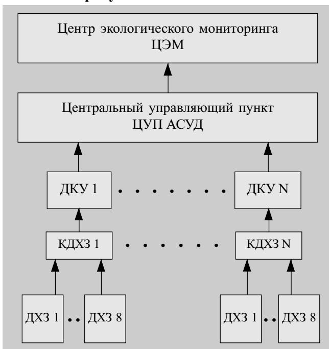
Датчики химических загрязнений (ДХЗ) стационарно устанавливаются на контролируемых автомагистралях и осуществляют непрерывный автоматический контроль токсичных веществ в воздухе заданной зоны контроля.
