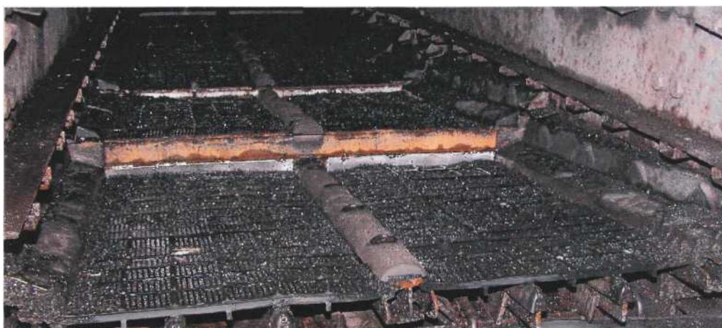
Рис. 5 - Лотки поперечно-лотковых сит (ПЛС), сформированные из СДАЛ тонкого грохочения по классу 0,5 мм на нижних ярусах вибрационных грохотов ГИСЛ-42
