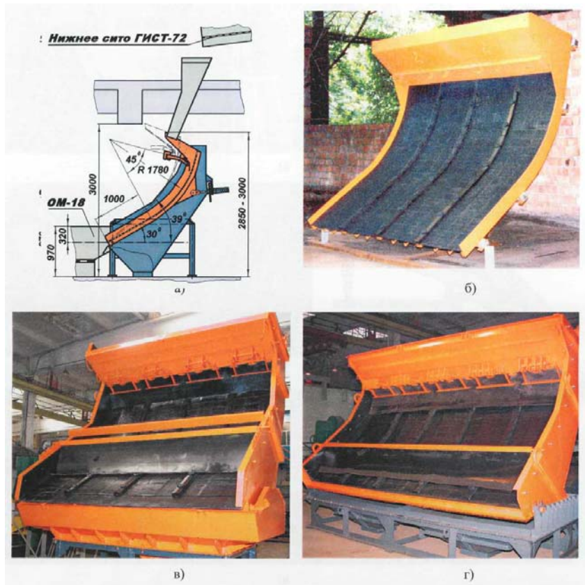
а) схема конструкции и привязки грохота дугового «ГДР-К» для ЦОФ «Кондратьевская»; б) рабочий орган грохота дугового «ГДР-К» для ЦОФ «Кондратьевская»; в) грохота дугового «ГДР-М» для «Моспинское УПП»; г) грохота дугового «ГДР-П» для ЦОФ «Павлоградская» Рис. 8 - Дуговые грохоты на основе СДАЛ для операций обезвоживания и обесшламливания перед отсадкой.
