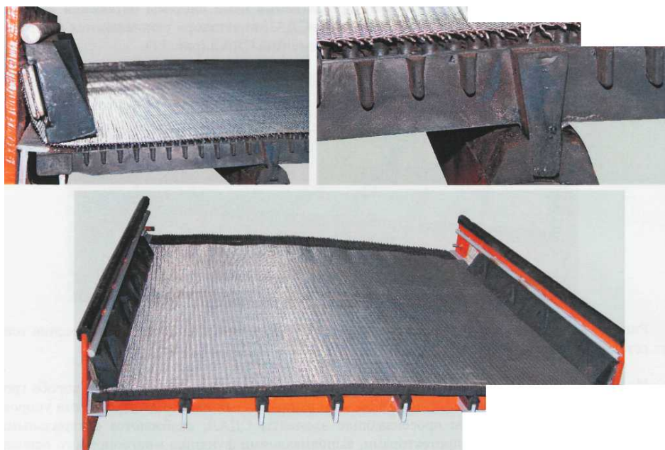
Рис. 14 - Система натяжения тонких сеток «СДАЛ-ипликатор» на амортизирующих основаниях с игольчатым протектором для грохота ГИСЛ-42.
