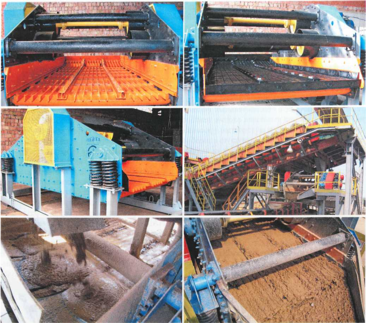
Рис. 7 - Обезвоживание грохочением по крупности 0,25 мм глинодержащих песков гидроциклонов и спиральных классификаторов 2КСН-24 на грохоте ГВЧ 6 I с повышенным вибродинамическим режимом и просеивающими поверхностями типа СДАЛ из многоопорных просеивающих элементов
