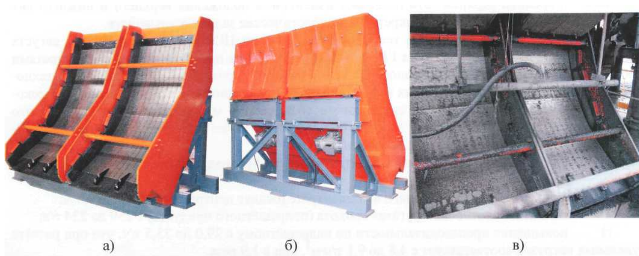
а) вид грохота со стороны рабочей поверхности; б) вид со стороны привода; в) ГДВР-2 в технологической линии шламоперерабатывающего комплекса ООО «Экоэнергоресурс» Рис. 10 - Дуговой вибрационный высокочастотный грохот ГДВР-2 сдвоенный.
