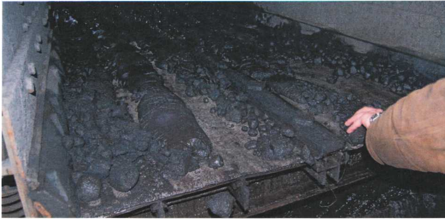
Рис. 17 - Обезвоживание шламов угольных концентратов грохочением по крупности 0,2 мм на грохоте ГВЧ-30 в технологической линии ЦОФ «Моспинское УПП».
