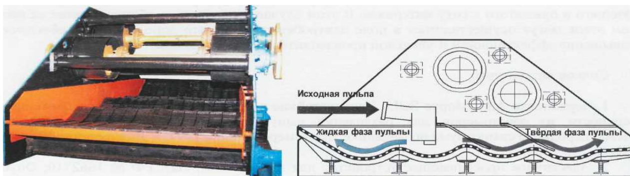
Рис. 18 - Общий вид и схема экспериментальной рабочей поверхности «Виброперекат» высокочастотного грохота ГВЧ-3,0.
