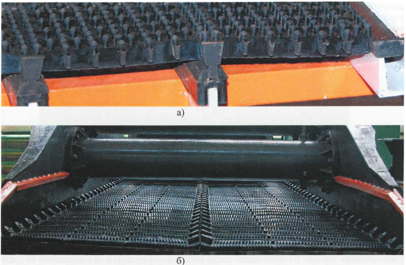
б) сегрегаторы и отражатели на рабочей поверхности СДАЛ тонкого грохочения Рис. 4 - Протекторы на рабочей поверхности СДАЛ: а) игольчатый протектор типа «СДАЛ-ипликатор».
