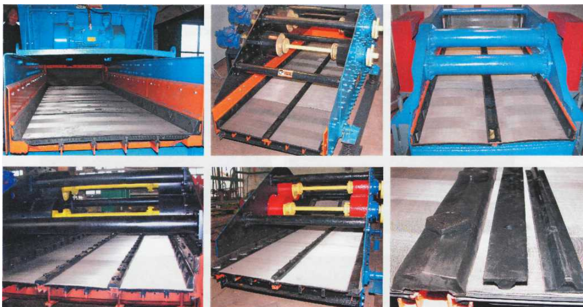
Рис. 16 - Высокочастотные грохоты HEIN LEHMANN UG 1,2 4,0/WSED; ГВЧ-30; ГЛКВ-3000; ГВЧ-61 и ГВЧ-41 с системами натяжения «СДАЛ-ипликатор» и дотяжителями, устанавливаемыми под промежуточными средними опорами.
