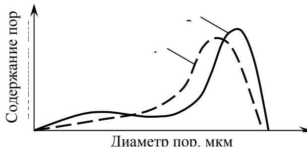
Рис. 1 – Типичные виды распределения пор в песчаниках по диаметру.
