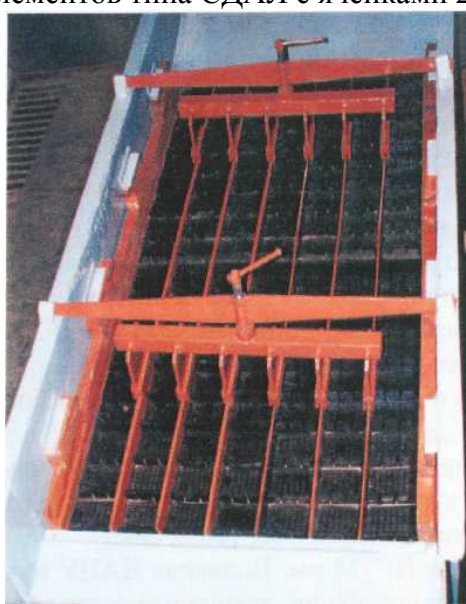
Рис. 5 - Отсадочная машина МОД-2 с решетами на основе просеивающих элементов типа СДАЛ
