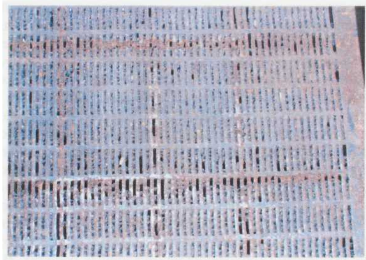
Рис. 1 - Вид штампованного щелевого решета отсадочной машины МОД-2 перед ежесуточной очисткой
