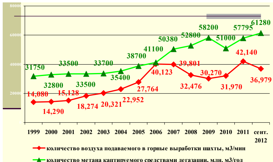
Рис. 12 – График расхода воздуха, подаваемого в горные выработки шахты и метана капируемого средствами дегазации на ш/у Покровское
