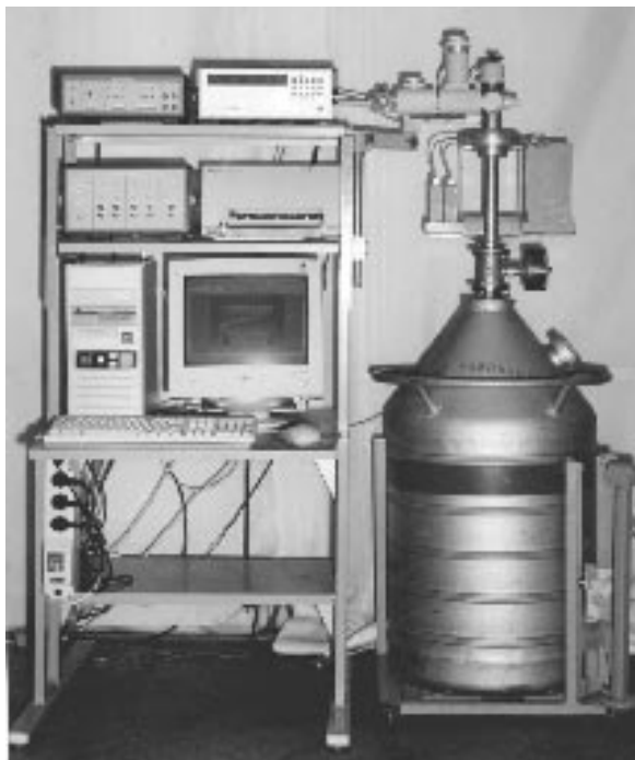
Рис. 3. Экспериментальная установка частотомера-спектроанализатора с использованием перехода Джозефсона
