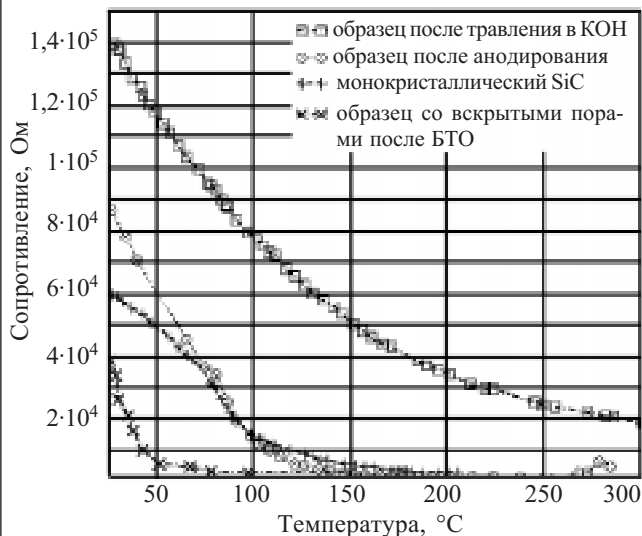
Рис. 8. Температурная зависимость сопротивления образцов 6H-SiC до и после анодирования
