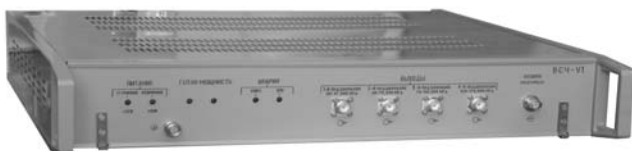
Рис. 4. Внешний вид базовой конструкции возбуждателя-синтезатора частот диапазона 30...180 МГц
