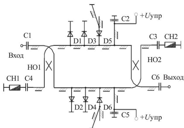
Рис. 2. Электрическая схема ограничителя
