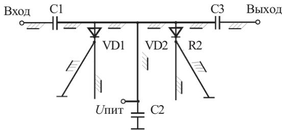
Рис. 3. Электрическая схема выключателя
