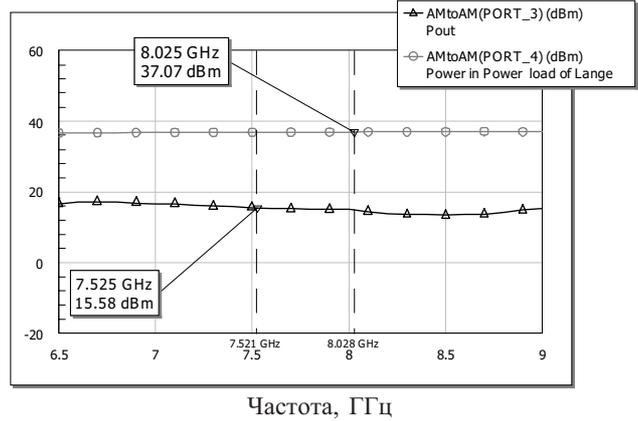
Рис. 4. Уровень сигнала на выходе и в нагрузке ограничителя:
