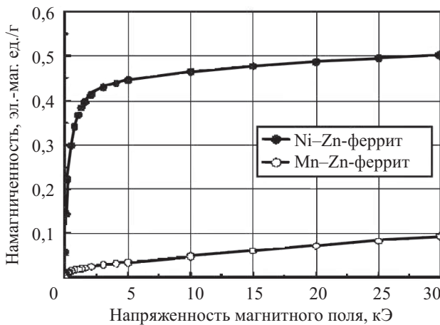
Рис. 5. Кривые намагничивания нанокompозитов, содержащих Ni-Zn- и Mn-Zn-ферриты, полученные при комнатной температуре
