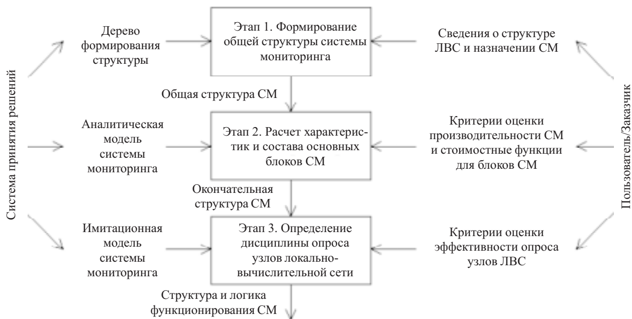
Рис. 2. Этапы формирования структуры системы мониторинга (ЛВС — локальная вычислительная сеть; СМ — система мониторинга)
