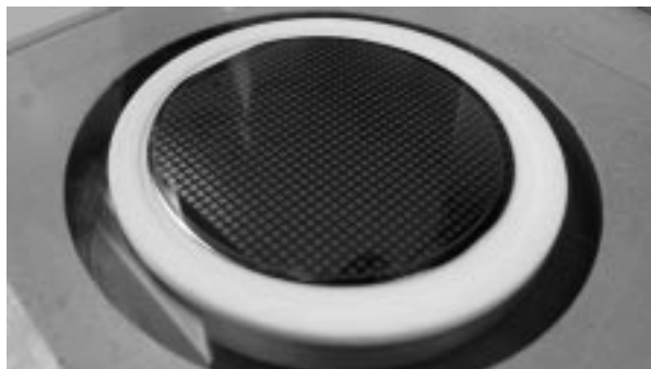
Рис. 1. Кремниевая пластина с композитной пленкой, разделенная на отдельные элементы
