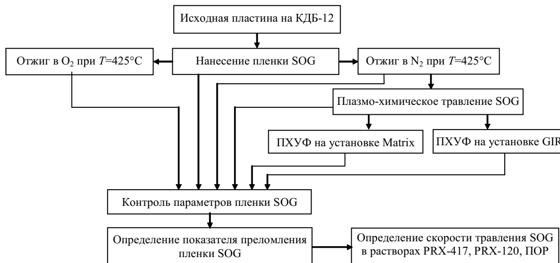
Рис. 2. Схема технологического маршрута для контрольных пластин
