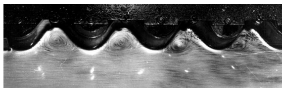
Рис. 6. Вихревая система, генерируемая бегущими волнами [5]
