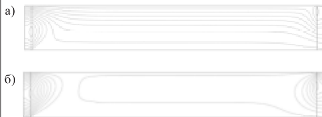
Рис. 3. Линии плотности электрического тока (а) и вихревых термоэлектрических токов (б)
