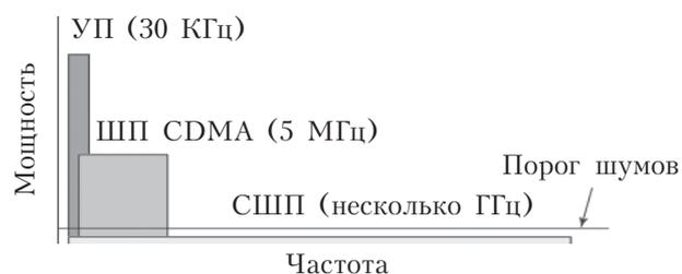
Рис. 1. Спектры узкополосного (УП), широкополосного, сверхширокополосного сигналов
