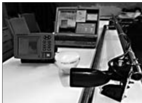
Рис. 2. Ехолот SEACHARTER 480 DF, гідроакустична антена, приймач GPS, універсальний пристрій для кріплення антени на борті судна та персональний комп'ютер із карт-рідером для читання й обробки ехограм
