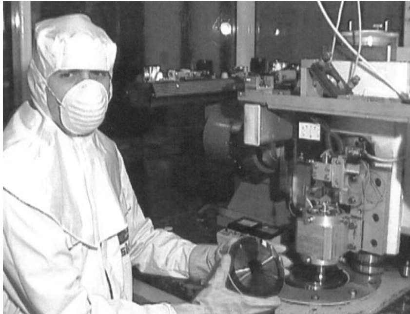
Рис. 6. Загальний вигляд станції лазерного запису дисків-оригіналів
