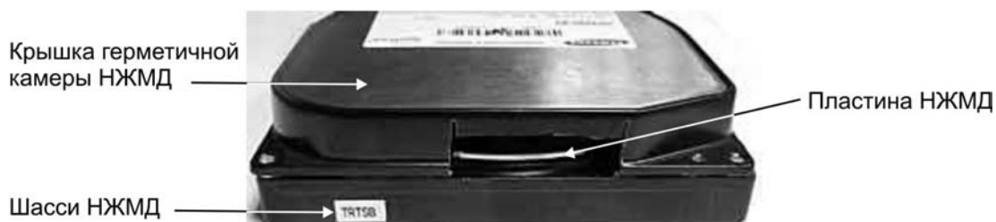
Рис. 8. Специально подготовленное отверстие в герметичной камере НЖМД
