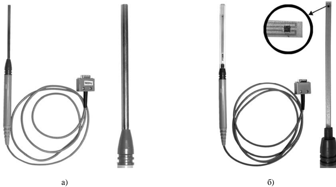
Рис. 6. Измерительные щупы: а) продольная составляющая поля; б) поперечная составляющая поля
