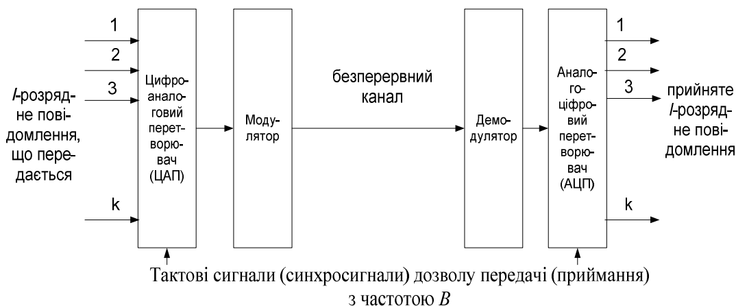
Рис. 4. Варіант підвищення пропускної спроможності аналогової лінії за рахунок передачі m < h^2 градацій (варіантів) сигналу
