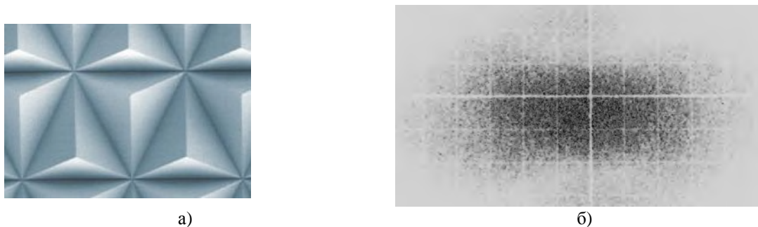
Рис. 4. Матриця (а) та структура відбитого променя (б) катафота компанії «Reflective Ireland Ltd.»
