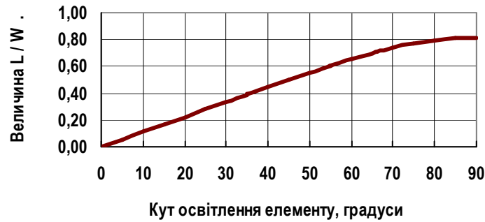
Рис. 2. Співвідношення між кроками L і W , при якому коефіцієнт активної апертури дорівнює 100 % для системи «полікарбонат–повітря»
