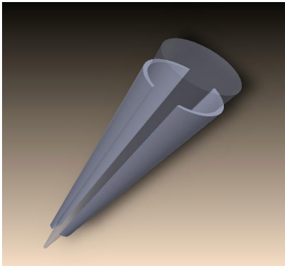
Рис. 2. TEM оптоволоконний зонд
