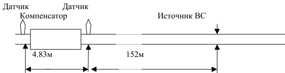
Рис. 9. Схема эксперимента по изучению прохождения волн через сальниковый компенсатор
