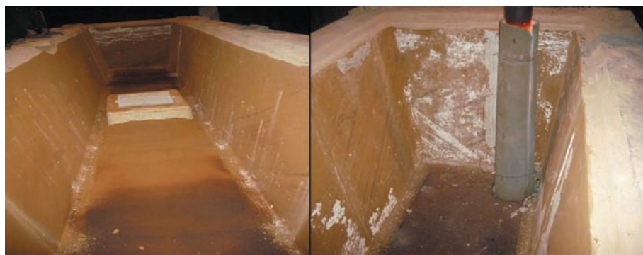
Рис. 3. Футеровка промежуточного ковша после термообработки (слева); промежуточный ковш перед разливкой: разогрев функциональных элементов (справа)
