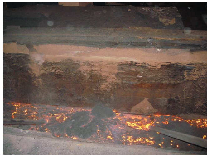
Рис. 4. Футеровка промежуточного ковша после разливки
