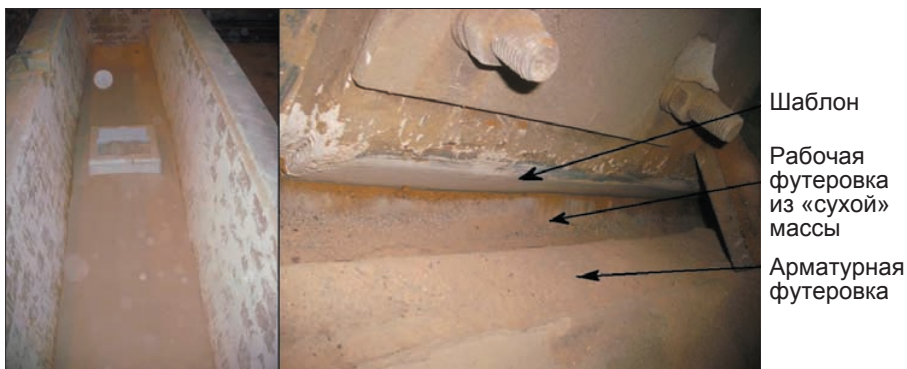
Рис. 2. Футеровка промежуточного ковша «сухой» массой: слева – футеровка дна до установки шаблона; справа – футеровка стены после засыпки массы и ее термообработки до удаления шаблона
