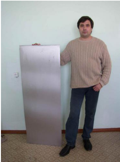
Рис. 4. Листовой наноструктурный полуфабрикат из титанового сплава VT6 с размерами 1500×500×2 мм
