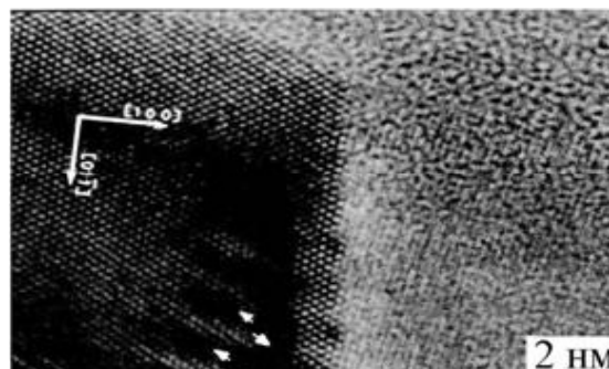
Рис. 1. Границы зерна в наноструктурированной меди
