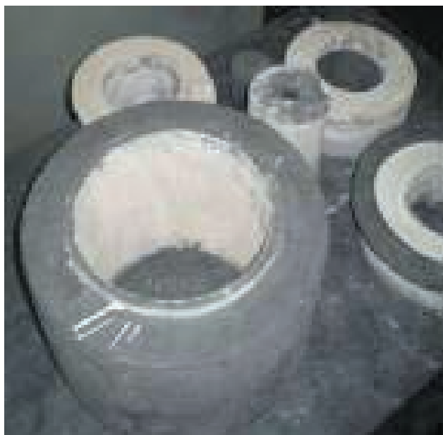
Рис. 35. Оснастка и пресс-форма в сборе
