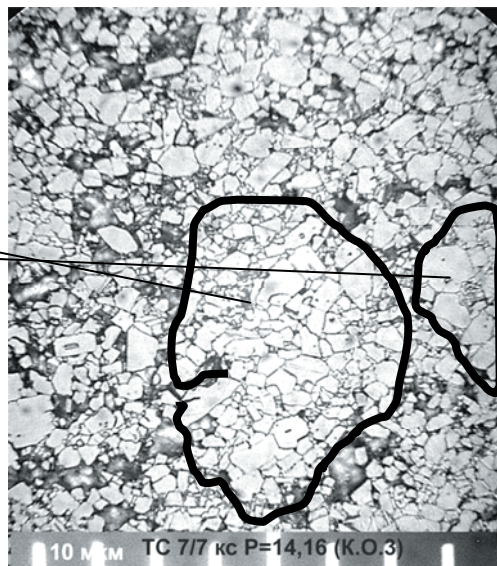
Рис. 19. Конгломераты в структуре спеченного сплава с 15 % связки
