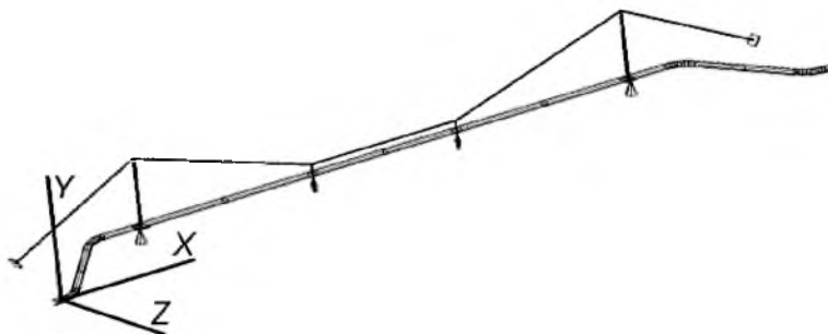
Рис. 11. Розрахункова модель вантового переходу за дії додаткового навантаження, побудована в ПК “3D PipeMaster”.
