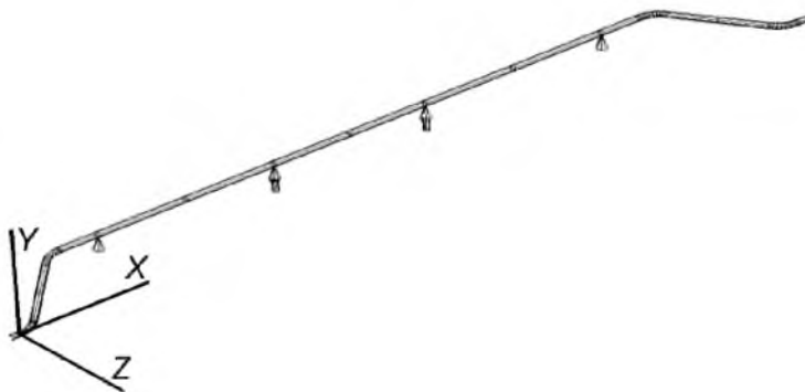
Рис. 5. Розрахункова схема повітряного переходу, побудована за допомогою ПК “3D Pipe Master”.
